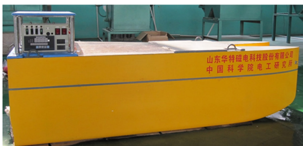
电磁流体海水浮油分离回收试验船
