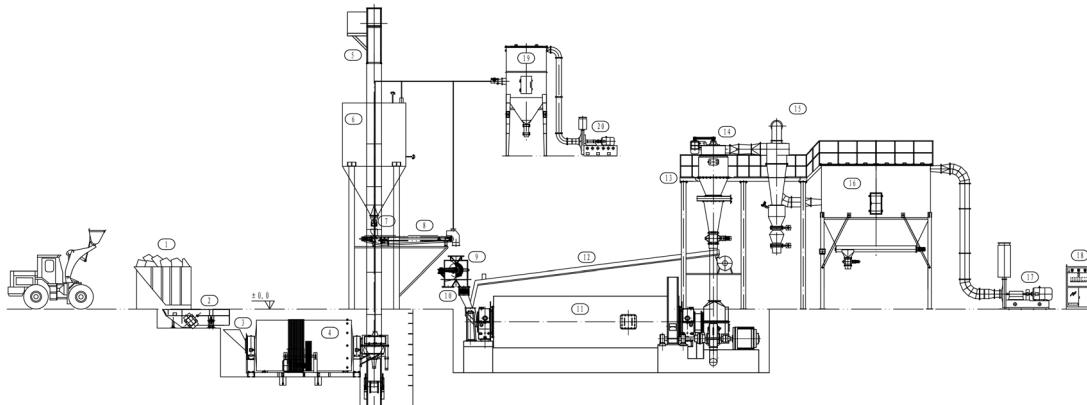
1、原矿仓 2、低矮式振动给料机 3、进料斗 4、制砂机 5、斗式提升机 6、原料仓 7、电动弧门 8、皮带秤 9、磁选机 10、格栅除铁器
