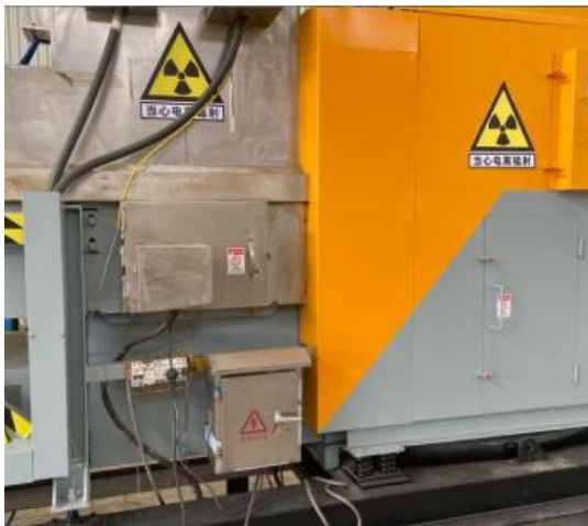
出入料口、设备两侧、X射线源箱体两侧等电离辐射警告标志
