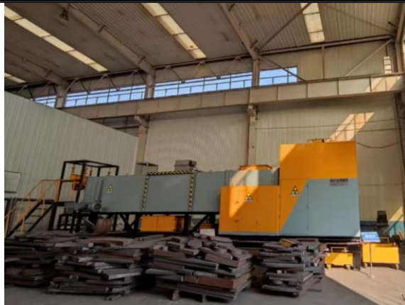
4#车间 X 射线矿石分选机成品展示实验区域 X 射线矿石分选机及控制室
