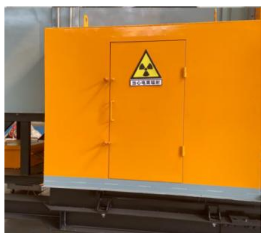
出入料口、设备两侧、X射线源箱体两侧等电离辐射警告标志
